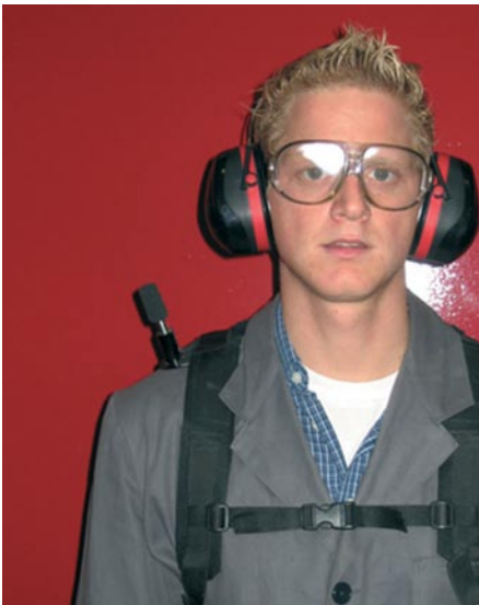
Abbildung 1: Nach ISO/DIS 9612 für Dosimetermessungen vorgegebene Mikrofonposition
