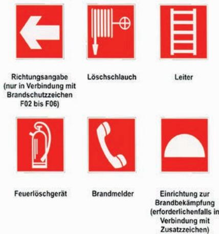
**Abbildung 1:** Kennzeichnung (F02 bis F06) von Einrichtungen zur Brandbekämpfung
