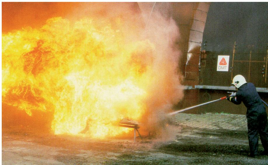
**Abbildung 5:** Falsches Ablöschen einer brennenden Staubschüttung mit Vollstrahl (Trainingszentrum der DMT in Dortmund)
