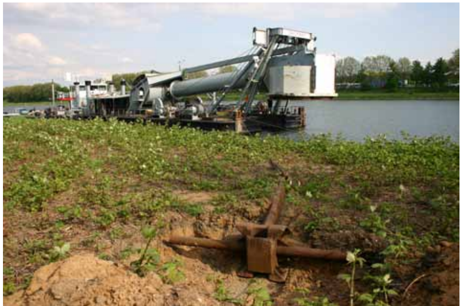
Abbildung 5: Das Taucherglockenschiff Carl Straat auf dem Rhein in seinem Heimathafen bei Duisburg. Die Carl Straat wurde 1963 auf der Werft Ohrenstein und Koppel/Lübecker gebaut. Die Länge beträgt 52,00 m und die Breite 11,80 m bei einem Tiefgang von 1,80 m. Als Antrieb dient ein Deutz Diesel 6 Zylinder mit 2 x 280 PS Voith Schneider Propeller. Der Betreiber ist das Wasser- und Schifffahrtsamt (WSA) Duisburg-Rhein. Seinen Namen verdankt das Schiff dem ersten Präsident (1946-1953) der ehemaligen WSD Duisburg Carl Straat. Dieses Spezialschiff ist einmalig in der Bundesrepublik Deutschland und wird auf dem Rhein zwischen Emmerich und Iffezheim sowie auf der Mosel von Koblenz bis Trier eingesetzt. Während des Kurses 2009 konnten die Kursteilnehmer diesen außergewöhnlichen Arbeitsplatz kennen lernen. Das Taucherglockenschiff Carl Straat erlaubt das Arbeiten im Trockenen unter Wasser. Am Heck der Carl Straat befindet sich die Tauchglocke, die mittels Luftüberdruck gegen eindringendes Wasser geschützt wird (Bild Schipke 2009).
